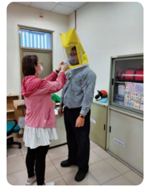
▲ 呼吸防護具 - 定性密合度檢測照片
