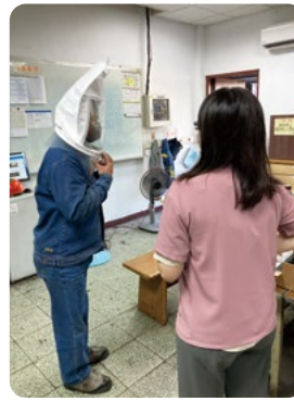
▲ 呼吸防護具 - 定性密合度檢測照片
