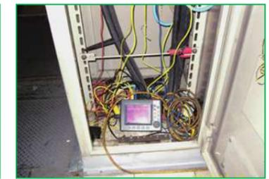
使用電力分析儀進行節能量測
