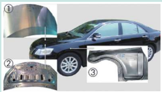
汽車材料：1.引擎蓋外板 2.引擎蓋內板 3.葉子板
