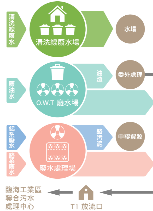
清洗線廢水處理場處理流程圖
