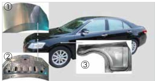
汽車材料 ①引擎蓋外板 ②引擎蓋內板 ③葉子板
